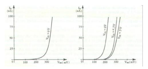
Come potete notare, essa è identica alla caratteristica di polarizzazione diretta del diodo. Ciò non ci deve sorprendere, perché, se polarizziamo soltanto la giunzione base-emettitore, con una batteria
