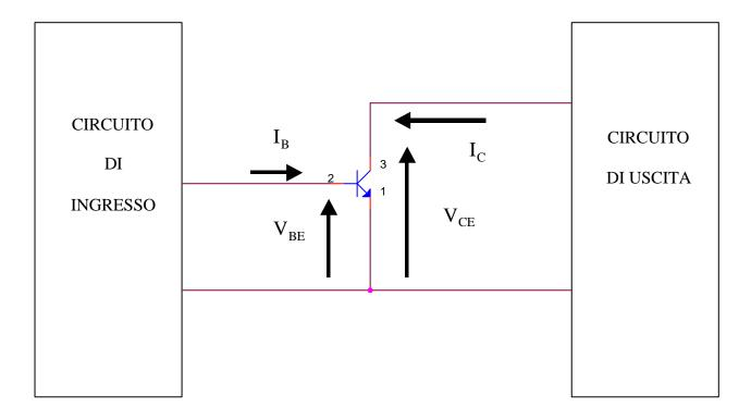
In questo caso l'emettitore è collegato sia al circuito di ingresso che a quello di uscita, cioè è comune alla maglia di ingresso e alla maglia di uscita. In tal caso le grandezze elettriche che vanno considerate come ingressi del dispositivo sono la corrente di base  $I_B$  e la tensione  $V_{BE}$ . Le grandezze che vanno considerate come uscite sono la  $I_C$  e la  $V_{CE}$ .
