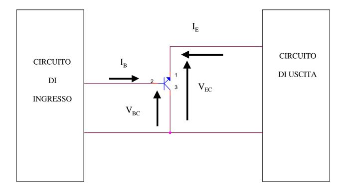
In tal caso è il collettore che viene collegato sia all'ingresso che all'uscita. Le grandezze di ingresso sono la corrente di base e la tensione fra base e collettore, mentre le grandezze di uscita sono corrente di emettitore e tensione fra emettitore e collettore.
