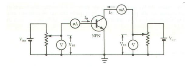
Poiché abbiamo grandezze di ingresso e di uscita abbiamo due caratteristiche: una di ingresso che esprime il legame fra  $I_B$  e  $V_{BE}$ , ed una di uscita che lega  $I_C$  e  $V_{CE}$ .
