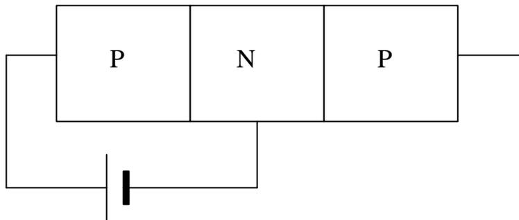
Per permettere alle lacune di passare nel collettore occorre creare un campo elettrico diretto dalla base al collettore per cui va inserita una nuova batteria
