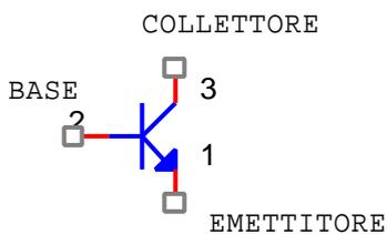
la freccia indica che la corrente di emettitore è in realtà positiva se è rivolta in uscita al dispositivo (infatti nel npn entrano elettroni).
