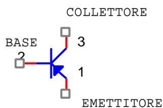
la freccia sull'emettitore indica che la corrente di emettitore è realmente positiva entrando nel dispositivo. Il simbolo del npn è invece il seguente
