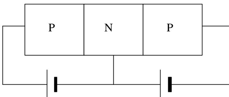
Sintetizzando, nel normale funzionamento del bjt, la prima giunzione va polarizzata direttamente mentre la seconda va polarizzata inversamente.
