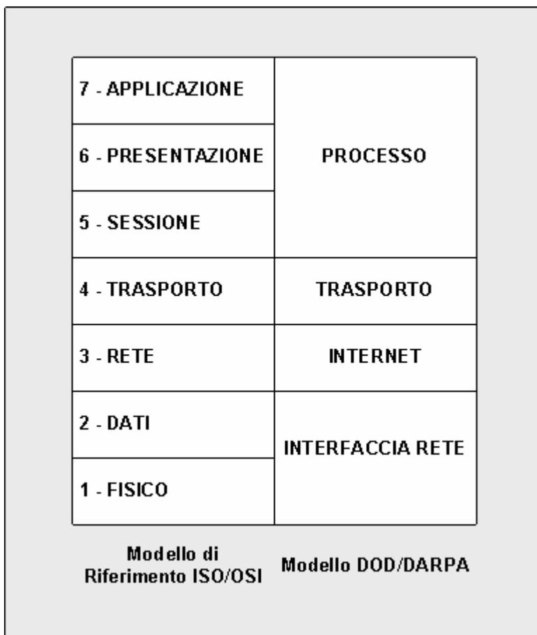
Figura 1: Confronto tra il modello di riferimento ISO/OSI ed il modello DoD/DARPA
