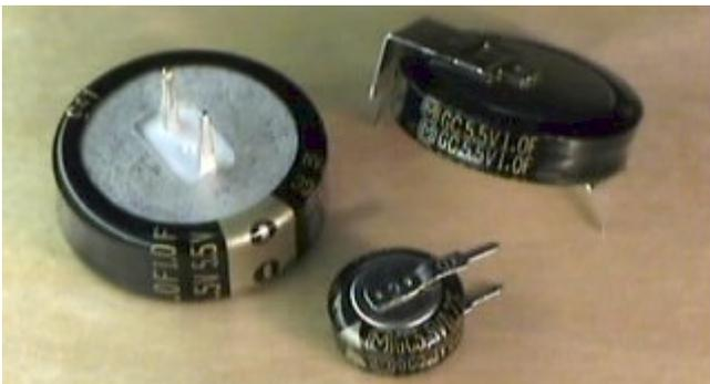
Sono condensatori polarizzati ad altissima capacità (da 0,1F a 10F).
