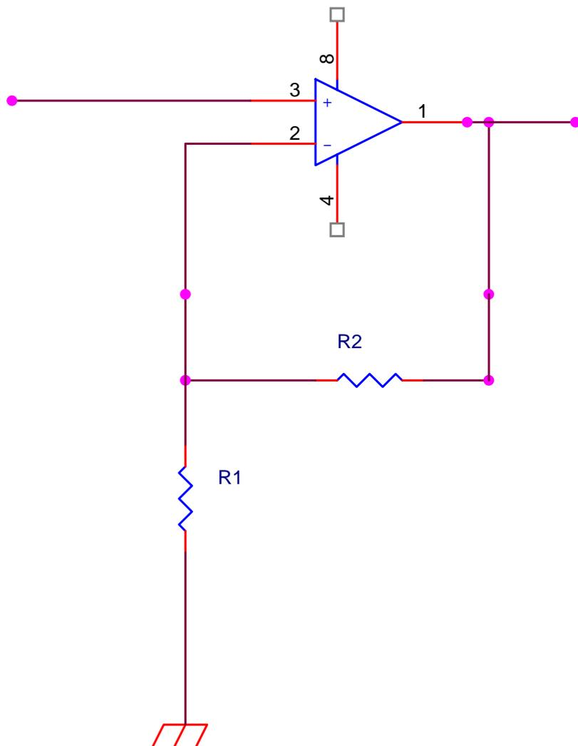
siamo di fronte ad un amplificatore in configurazione non invertente e abbiamo l'amplificazione massima pari a  $1 + \frac{R_2}{R_1}$ .
