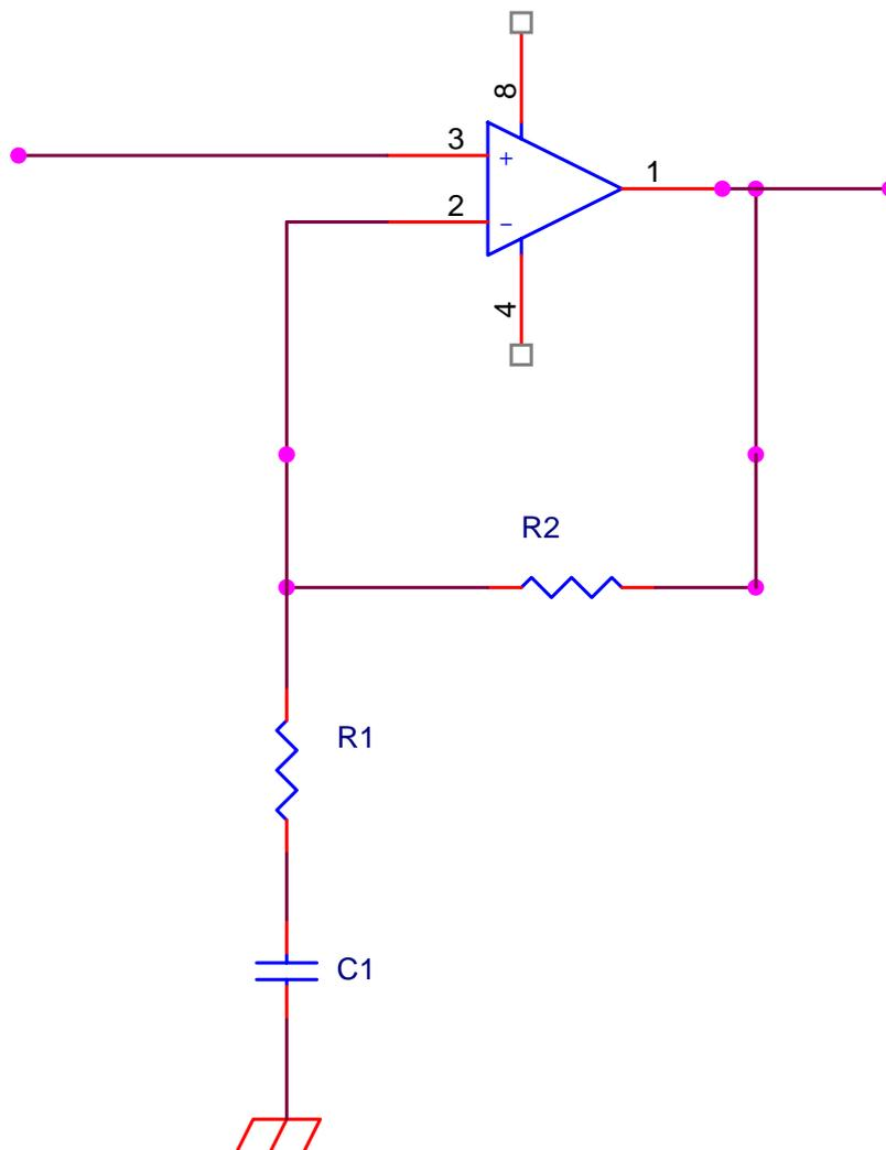
e l'amplificazione è data dalla formula  $1 + \frac{R_2}{Z_1}$  dove  $Z_1$  decrescerà via via che diminuisce la reattanza offerta dal condensatore, facendo così aumentare il fattore di amplificazione complessivo. Per certi valori di frequenza intermedi il primo condensatore può essere ancora considerato un cortocircuito mentre il secondo condensatore ( se lo prendiamo molto più piccolo) è ancora un circuito aperto.
