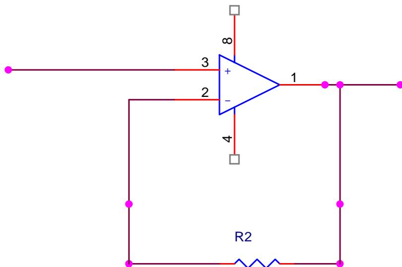
in sostanza un buffer che, dunque, non amplifica. Al crescere della frequenza non si può più ignorare il condensatore  $C_1$
