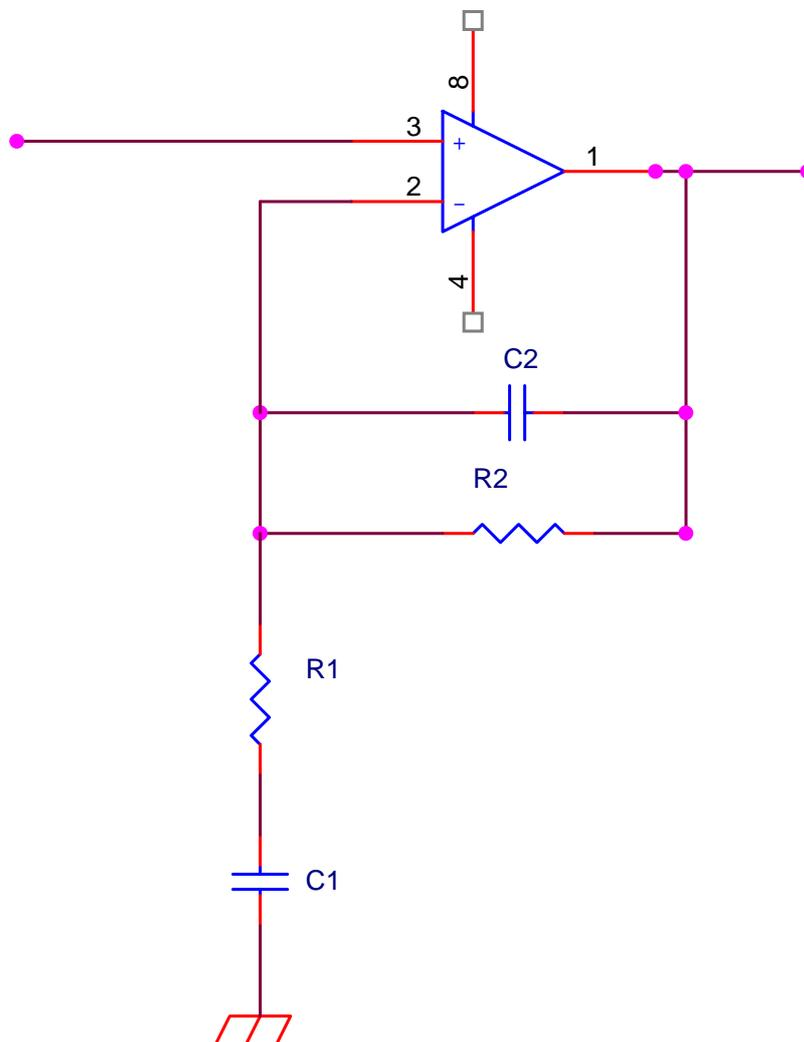
Anche in questo caso  $C_1$  introduce una frequenza di taglio inferiore mentre il condensatore  $C_2$  introduce una frequenza di taglio superiore.
