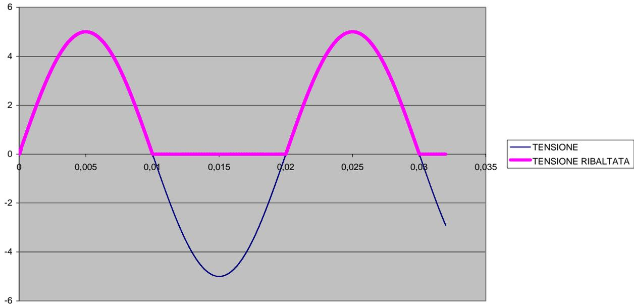
e circuiti raddrizzatori a doppia semionda, in cui la parte negativa dell'onda non viene soppressa ma ribaltata in modo da farla diventare positiva.
