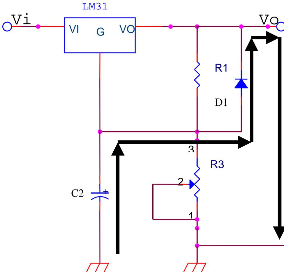
Discorso analogo si può fare per il condensatore C2 collegato al morsetto di adjustment. In questo caso il condensatore potrebbe scaricare pericolosamente attraverso l'integrato, nel caso di cortocircuiti in uscita. Il diodo D1 è normalmente polarizzato inversamente ma, in caso di cortocircuito sull'uscita, esso entra in conduzione creando un percorso alternativo per la scarica del condensatore.
