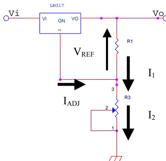
il dispositivo è progettato per mantenere costante non la tensione di uscita  $V_o$  ma la tensione compresa fra il morsetto di uscita e il morsetto di adjustment, detta tensione
