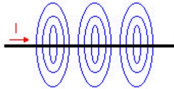
Il fenomeno dell'**induzione elettromagnetica** si ha quando un circuito, percorso da corrente, genera una tensione su un circuito vicino senza una connessione fisica, ma solo per via magnetica. Perché ciò accada dobbiamo trovarci in presenza di due condizioni:
