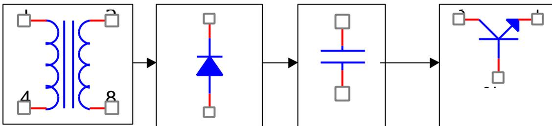
IL primo blocco è un blocco trasformatore. I trasformatori sono usati per aumentare o diminuire tensioni e correnti continue in un circuito. Essi sono basati sul principio a voi certamente noto della mutua induttanza<sup>1</sup>
