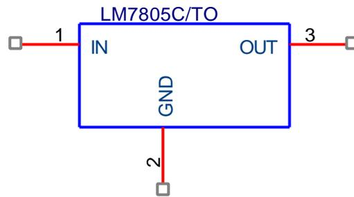
abbiamo tre morsetti di cui il primo è il morsetto cui si applica la tensione variabile di ingresso, il secondo è un morsetto che va collegato alla massa del circuito, il terzo è il morsetto sul quale abbiamo la tensione stabilizzata di uscita. Per inserire questo dispositivo in maniera corretta in un alimentatore stabilizzato occorre conoscere alcune cose:
