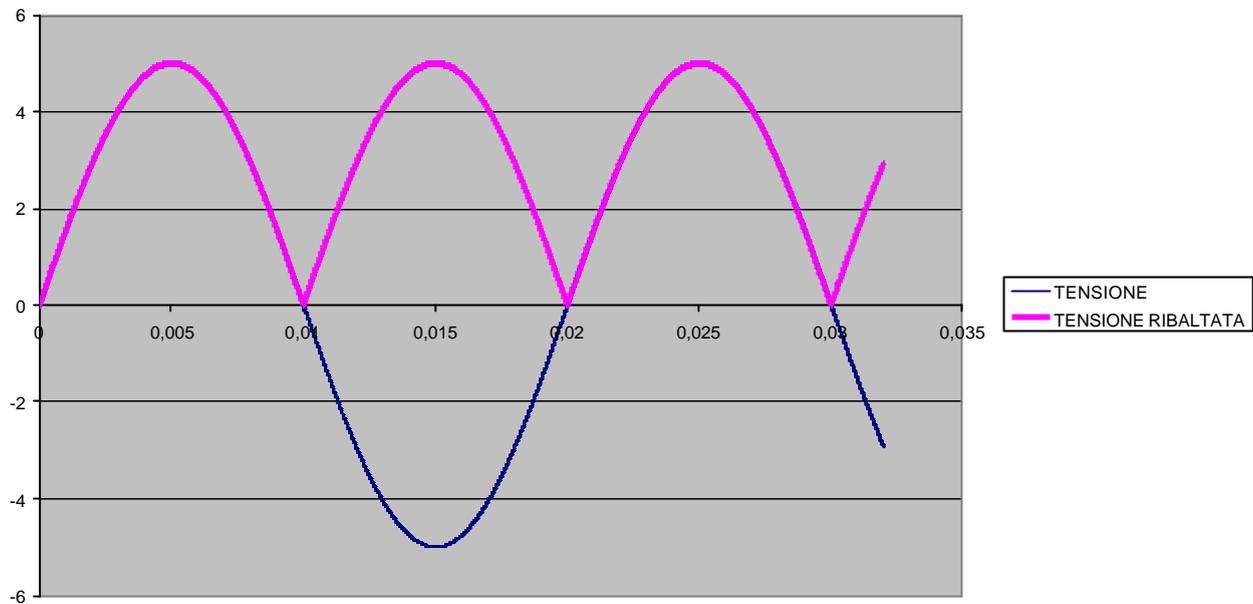
Il blocco di filtro consiste sostanzialmente nel condensatore che, nei vari circuiti citati nella nota precedente, veniva posto in parallelo all'uscita del circuito raddrizzatore in modo da approssimare l'onda ottenuta dal circuito raddrizzatore ad un'onda continua
