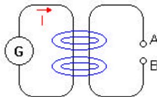
Nell'esempio in figura il generatore **G**, presente nel primo circuito, fa circolare una corrente variabile **I**. Il flusso magnetico variabile (in blu) così generato si concatena col secondo circuito elettrico. Tra i punti **A** e **B** compare una tensione che viene definita **indotta**. La tensione indotta è tanto più elevata quanto più rilevante è la variazione del flusso magnetico concatenato e quanto più veloce è la variazione.
