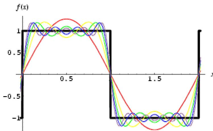
Si può dire che più un segnale varia lentamente minore è il contributo delle armoniche superiori. In sostanza il condensatore che introduciamo nell'alimentatore, addolcisce la forma dell'onda filtrando le armoniche di ordine superiore, da cui il nome di filtro.
