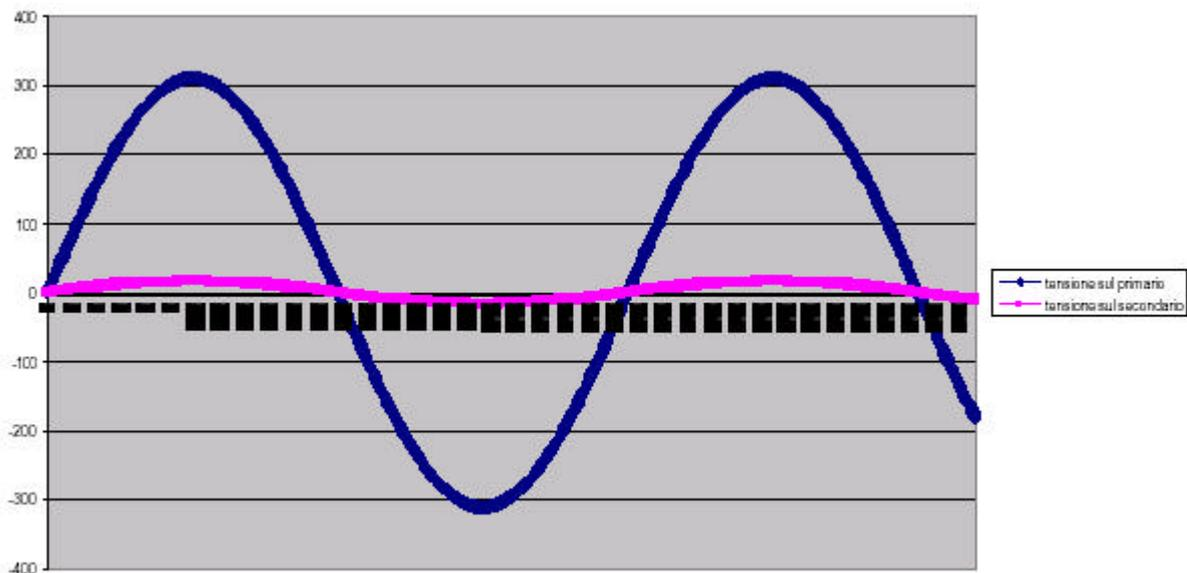
IL secondo blocco , che abbiamo contraddistinto con un diodo, è il blocco raddrizzatore. Già abbiamo incontrato circuiti raddrizzatori<sup>2</sup> e sappiamo che il loro scopo è quello di eliminare le parti negative del segnale alternato che si ottiene sul
