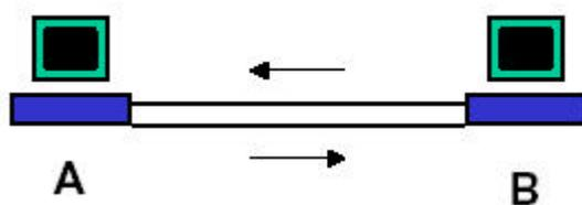
in cui il canale collega soltanto due computer ai suoi estremi . i due computer possono utilizzare il canale in maniera paritetica.
