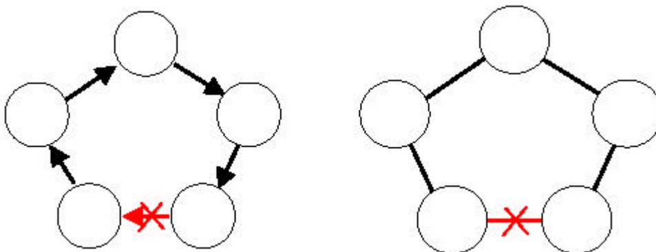
Nella disposizione fisica, la rete ad anello sembra seguire lo stesso schema della rete a stella. La differenza sostanziale è l'unità di connessione, conosciuta come Multi-Station Access Unit (MAU). Nella MAU, i segnali dei dati passano, in un anello, da
