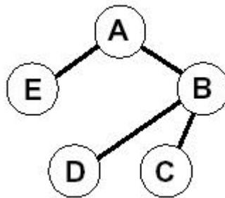
In questa topologia i costi di connessione sono bassi poiché le connessioni necessarie per una rete di N nodi sono solo N-1 ma vi è una forte vulnerabilità ai guasti. Nell'esempio, un'avaria del nodo B isola anche i nodi D e C. In questa topologia è pensabile un solo percorso fra due nodi della rete.
