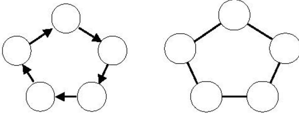
Ogni nodo dell'anello è collegato con 1 nodo che lo precede e il nodo che lo segue in un percorso chiuso. Si può avere un collegamento unidirezionale (per cui i dati possono percorrere al rete soltanto in un senso) o bidirezionale. Il numero di collegamenti è  $N-1$  per una rete ad anello unidirezionale, mentre è  $N$  per un anello bidirezionale.
