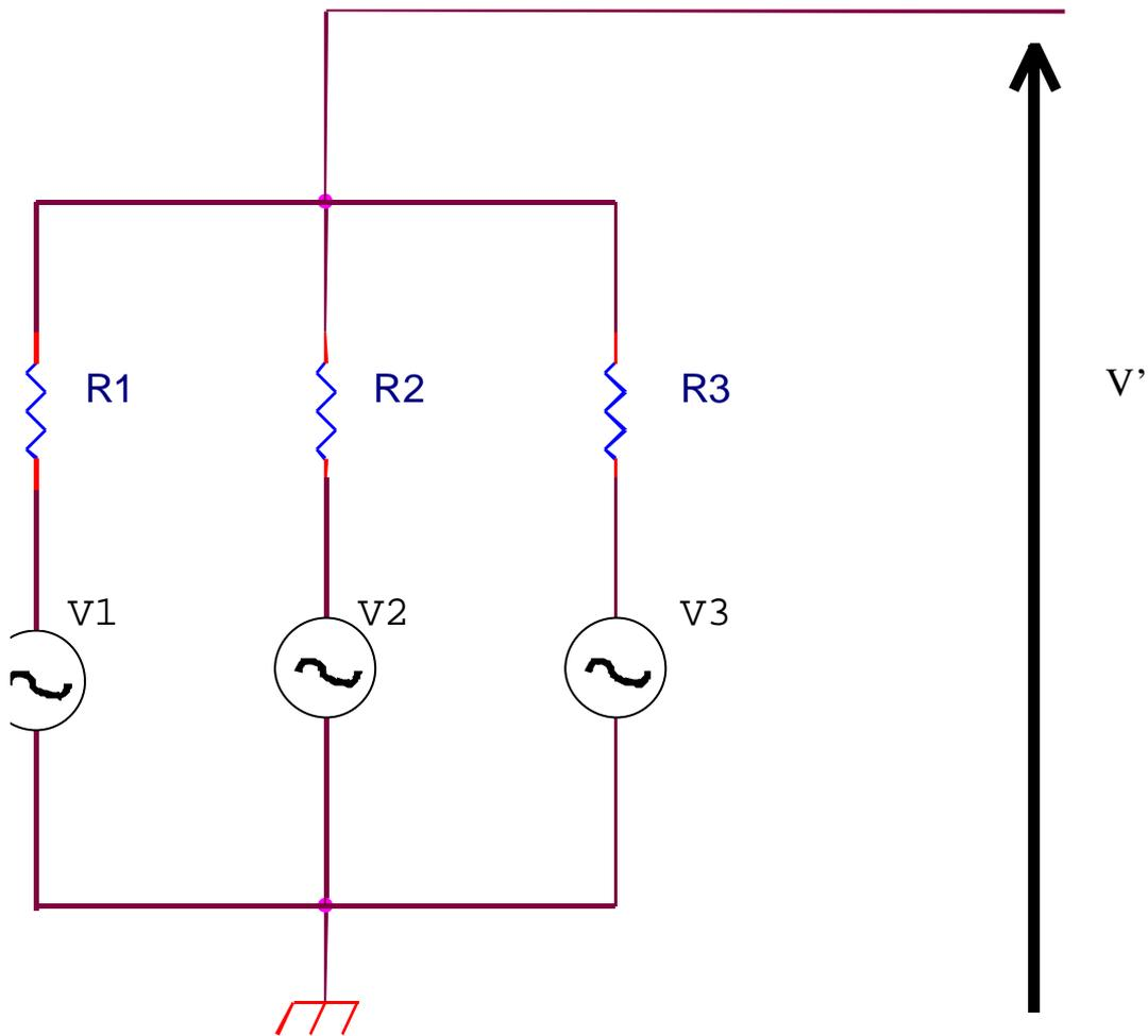
Abbiamo tre rami in parallelo ciascuno dei quali è costituito dalla serie di una resistenza e un generatore di tensione. Ora i lettori esperti di fisica delle particelle, buchi neri, quark e nebulose, sanno che per ricavare la tensione  $V'$  occorre applicare il teorema di Millmann
