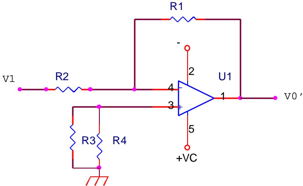
ma il parallelo fra  $R_3$  ed  $R_4$  si trova in serie con la resistenza d'ingresso dell'operazionale che è infinita per cui possiamo considerare nulla la sua influenza e abbiamo il seguente circuito
