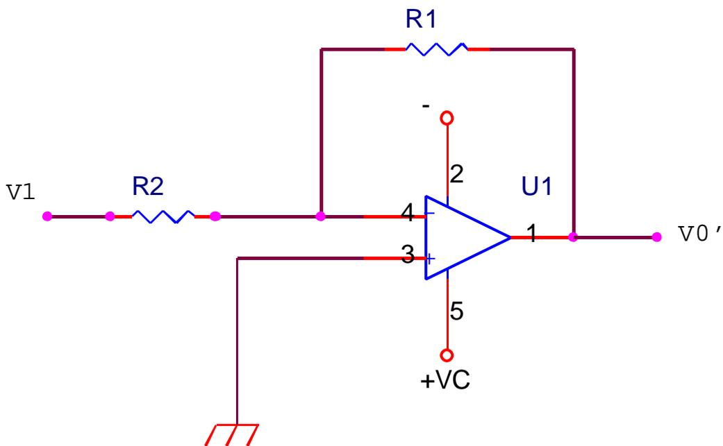
che costituisce un amplificatore in configurazione invertente. In definitiva
