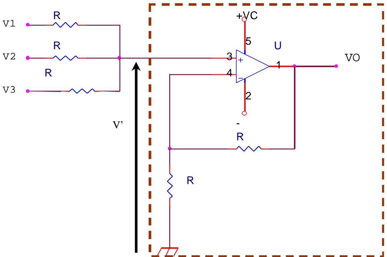
la parte di circuito racchiusa nel riquadro costituisce un normale amplificatore in configurazione non invertente che amplifica la tensione  $V'$ . Dunque si ha
