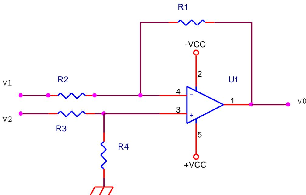
questo circuito fa in modo che la tensione di uscita sia proporzionale alla differenza fra le due tensioni di ingresso. Per studiare il legame ingresso-uscita, tenendo presente che ci troviamo di fronte ad un circuito lineare possiamo applicare il principio di sovrapposizione degli effetti.
