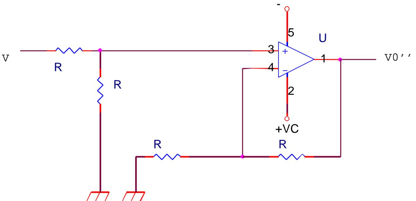
Notiamo che ora siamo di fronte ad un circuito amplificatore non invertente che amplifica non la  $V_2$  ma la tensione ai capi di  $R_4$
