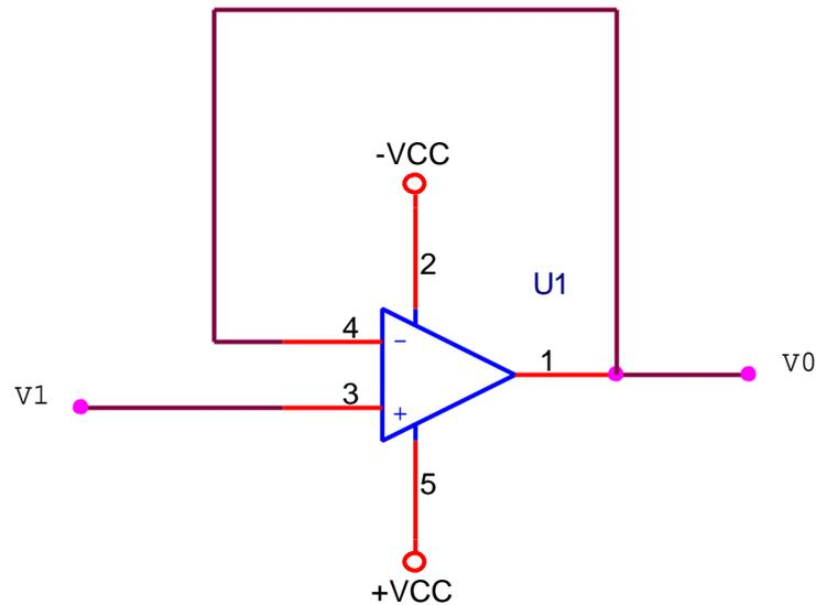
questo circuito è detto anche inseguitore di tensione poiché la tensione di uscita è esattamente pari alla tensione di ingresso:  $V_O = V_I$ . Basta osservare che ci troviamo di fronte ad una configurazione non invertente
