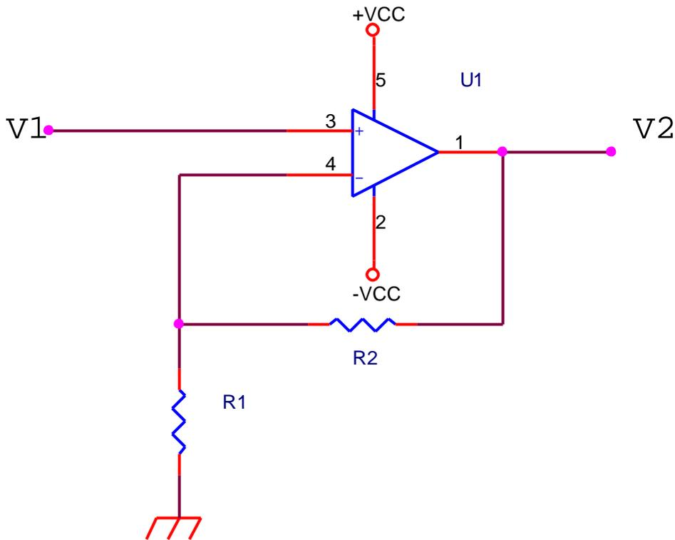
in cui  $R_2=0$  e  $R_1$  non c'è, il che equivale a dire che abbiamo messo una resistenza di valore infinito.
