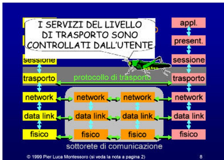
in sostanza il livello di trasporto può porre rimedio ai pacchetti perduti, ai dati danneggiati al reset delle connessioni da parte del livello di rete. Inoltre il livello di trasporto rende la rete di comunicazione trasparente alle applicazioni. In sostanza grazie a questo strato si possono scrivere applicazioni senza tener conto delle differenze delle interfacce che compongono le varie sottoreti di comunicazione.
