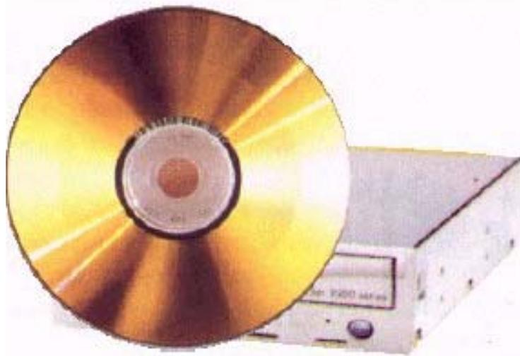
Nelle memorie a disco ottico la memorizzazione avviene effettuando dei piccolissimi "fori" sulla superficie di un sottile strato di alluminio annesso all'interno di un materiale plastico che fa da supporto del disco stesso. I minuscoli fori vengono realizzati vaporizzando l'alluminio tramite impulsi di luce laser all'infrarosso, generata dalla testina di scrittura del "masterizzatore", che è il nome del drive in grado di scrivere i CD.
