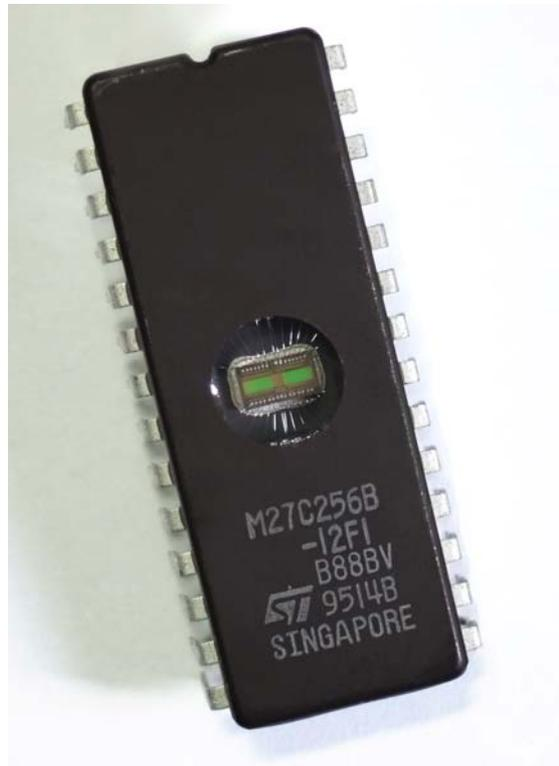
Sono stati prodotti diversi tipi di EPROM che si differenziano - oltre che per la capacità di memoria disponibile, anche per la velocità (tempo di accesso) e per le tensioni di lavoro e di programmazione.
