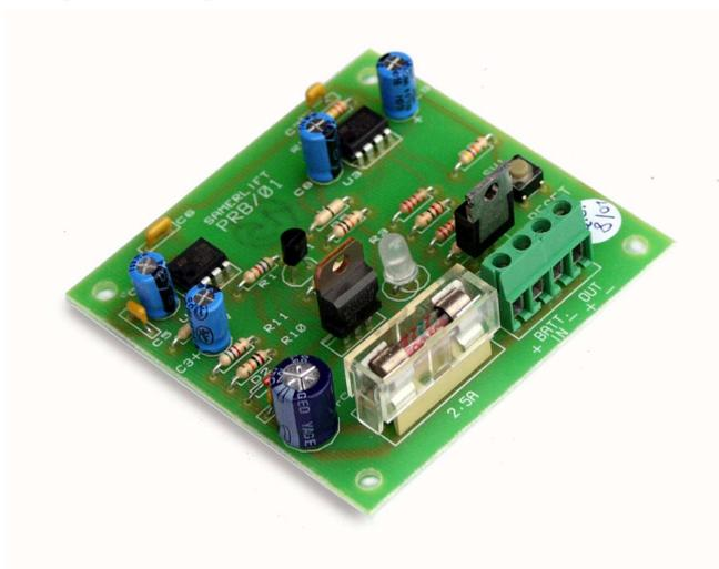
Scheda per la prevenzione della scarica della batteria.
