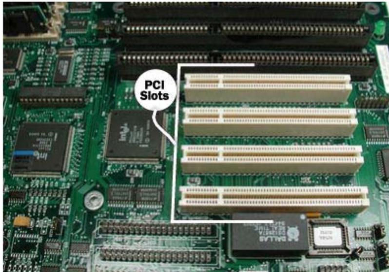
I dispositivi che si vogliono collegare alla scheda debbono essere dotati di [connessioni](#) a pettine da incastrare negli slot creando automaticamente le connessioni elettriche richieste.
